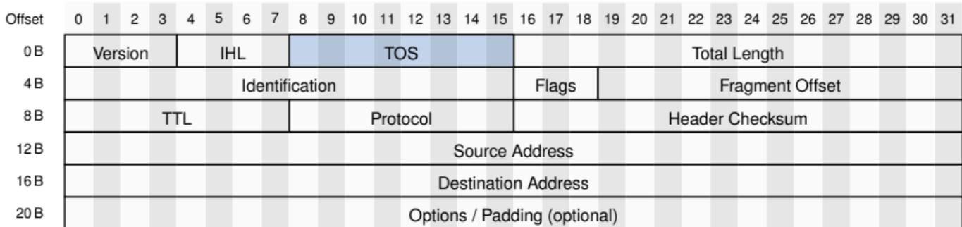
Abbildung 1: IPv4-Header (minimale Länge: 20 B)
