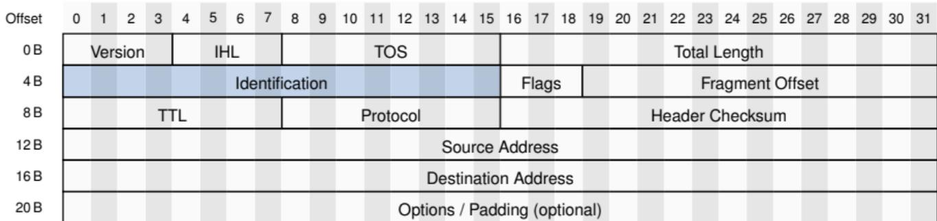
Abbildung 1: IPv4-Header (minimale Länge: 20 B)
