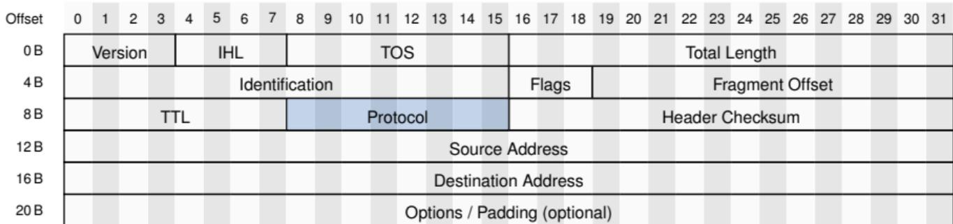
Abbildung 1: IPv4-Header (minimale Länge: 20 B)
