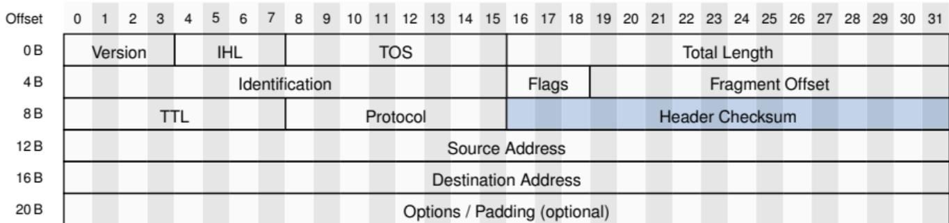
Abbildung 1: IPv4-Header (minimale Länge: 20 B)
